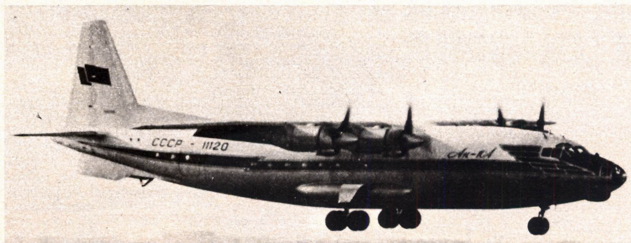
L'« Antonov », il maggiore apparecchio da trasporto sovietico. Il suo carico può arrivare a 120 tonn.
